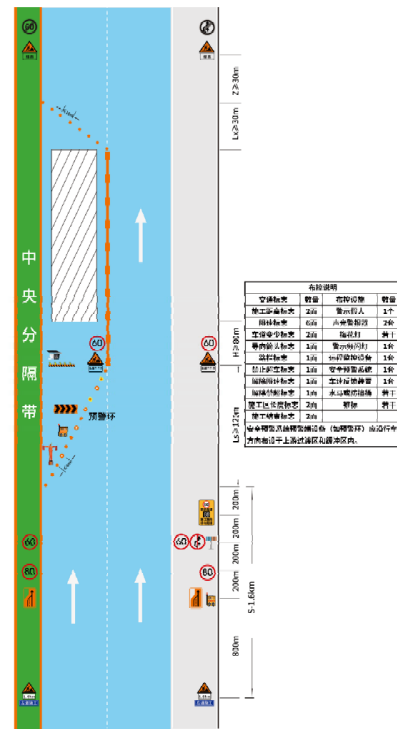
封闭超车道养护作业控制区示意图
